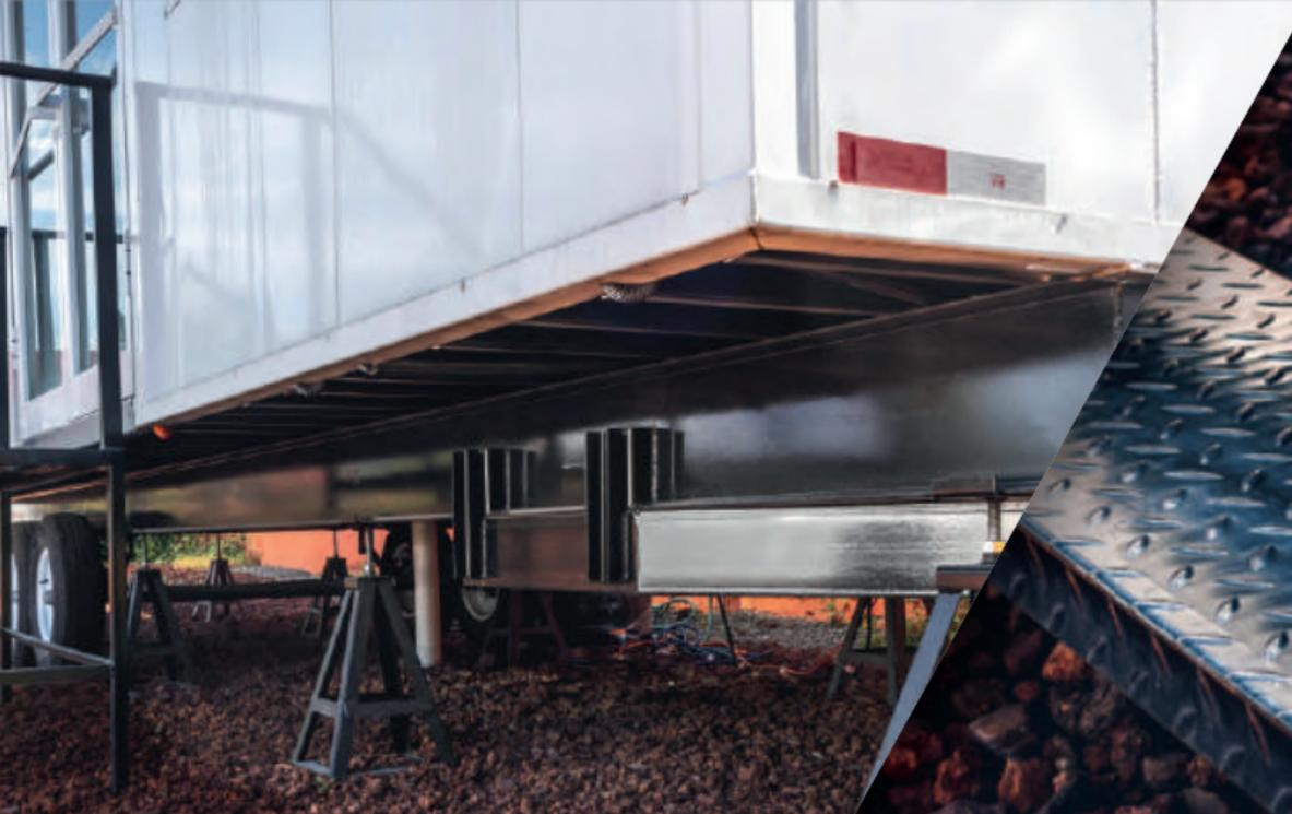
Chasis fabricado en acero estructural, procedimiento de soldadura semiautomático "MIG", aplicación de protección anticorrosiva.
