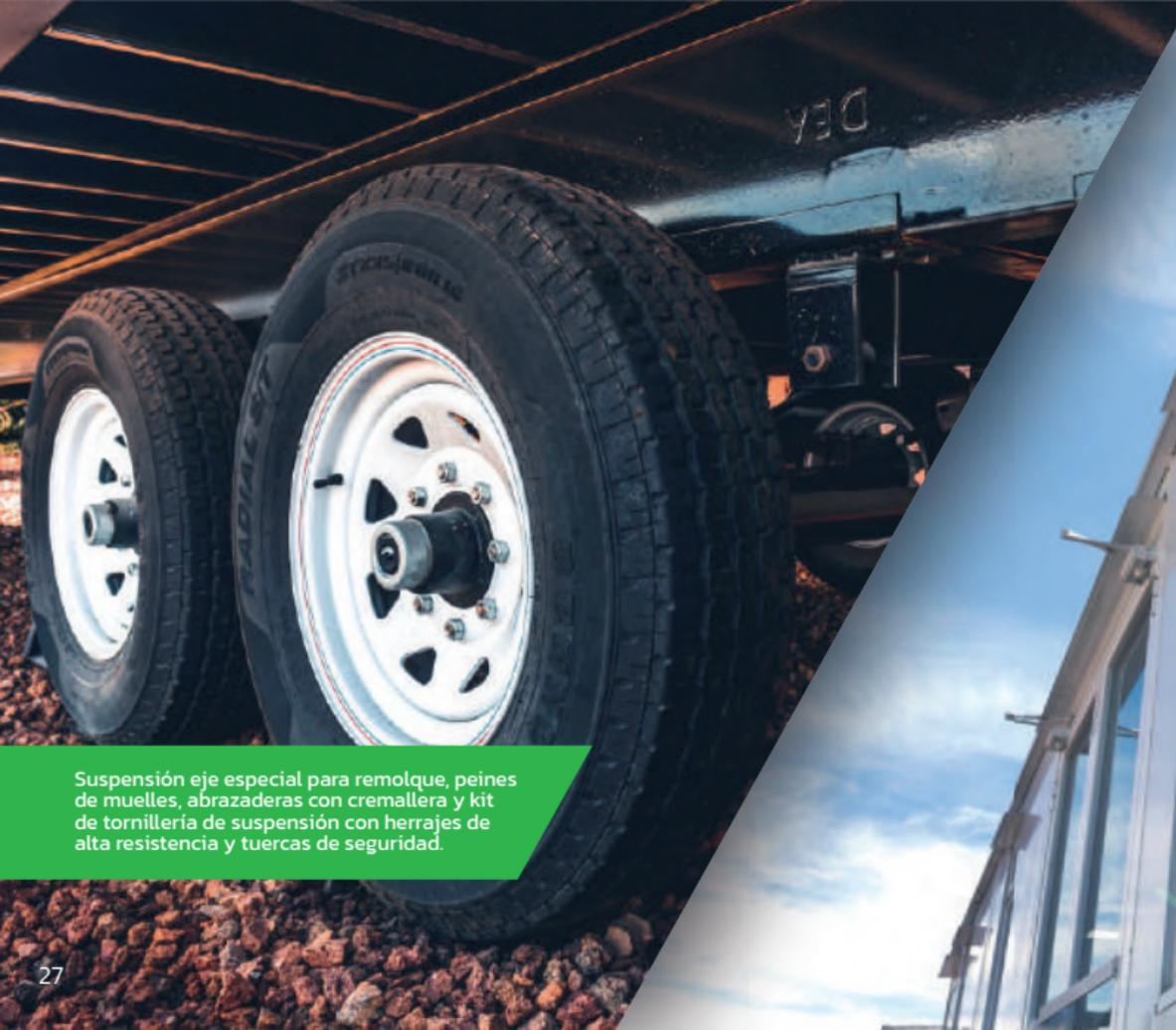
Suspensión eje especial para remolque, peines de muelles, abrazaderas con cremallera y kit de tornillería de suspensión con herrajes de alta resistencia y tuercas de seguridad.
